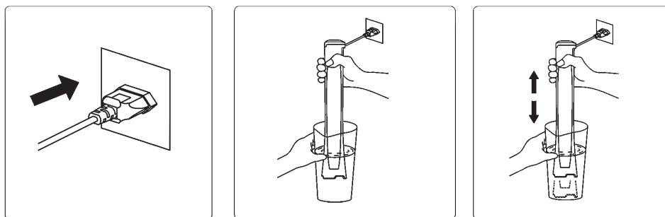
Перед первым использованием вымойте головку блендера водой с мылом. Не погружайте блендер в воду целиком. Мыть под струей воды допустимо лишь нижнюю часть корпуса длиной 210 мм вместе с головкой. Верхнюю часть корпуса протрите влажной тряпкой.
