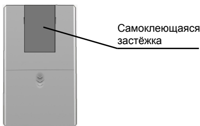
Рис.13 Место наклеивания застёжки
