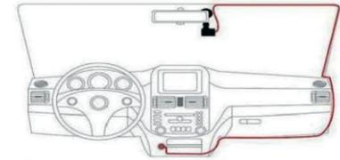
**Примечание.** Вы можете сделать скрытую проводку, пропустив провод зарядного устройства вдоль кромки ветрового стекла, как показано на рисунке выше.
