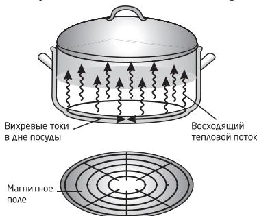
Индукционная плита имеет катушку (индуктор), изготовленную из многожильного провода с изолированными жилами. Когда переменный ток высокой частоты проходит через катушку, в ней и вокруг нее создается переменное электромагнитное поле. Если поместить кастрюлю с дном из ферромагнитных материалов на индукционную плиту, то электромагнитное поле создаст в нем электрический ток, который приведет к нагреву материала дна кастрюли (эффект Джоуля).
